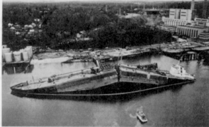
Fig. 9.2 Navio com fratura abrupta devida à fragilização do material. [Callister, 1994.]
